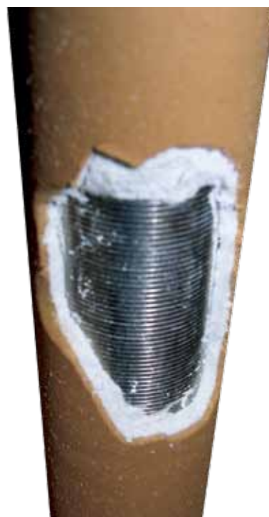
Ukázka rovnoměrného naplavení jednotlivých vrstev křemeliny na svíčke
