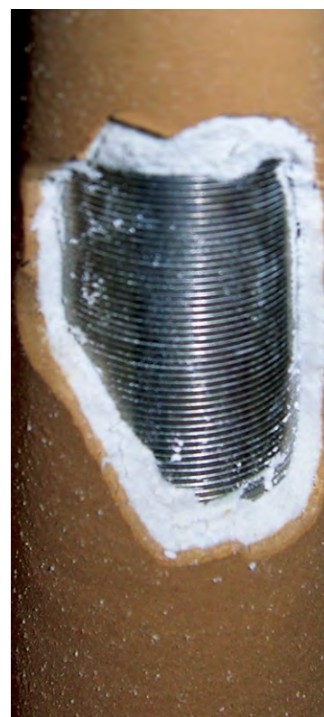
Внешний вид равномерного намыва нескольких слоев кизельгура на свече.
